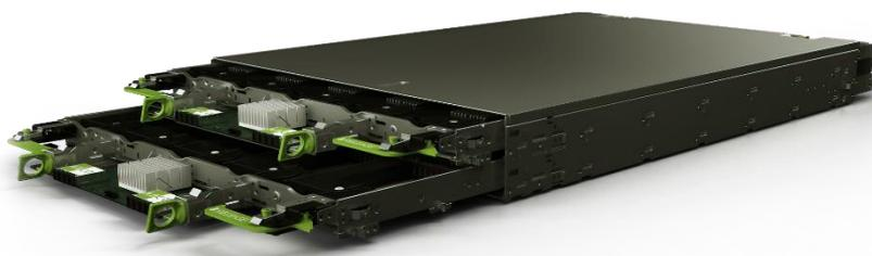
Модуль хранения Delta «Argut» Hybrid предназначена, как для расширения дискового пространства имеющихся серверов, так и для использования в составе программно-определяемых систем хранения данных, которые предлагают гибкие возможности для организации горячего или холодного хранения. Модуль хранения Delta «Argut» Hybrid от Delta Computers разработан и произведен в России.
