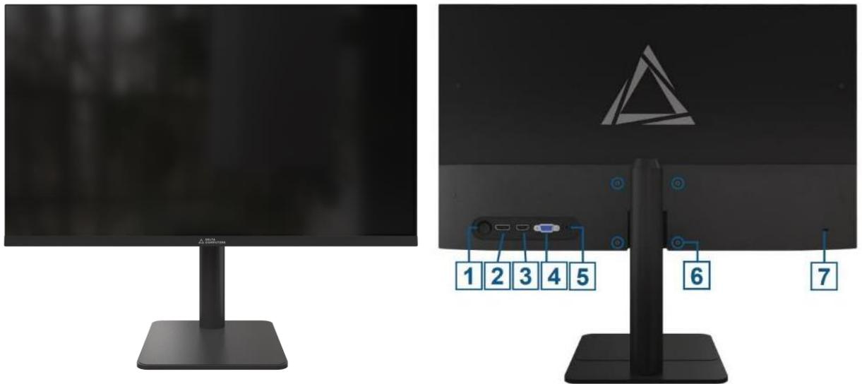
1 - джойстик управления с интегрированной кнопкой питания; 2 - Display Port; 3 - HDMI; 4 - VGA; 5 - разъем питания; 6 - крепление VESA; 7 - разъем под замок Kensington lock
